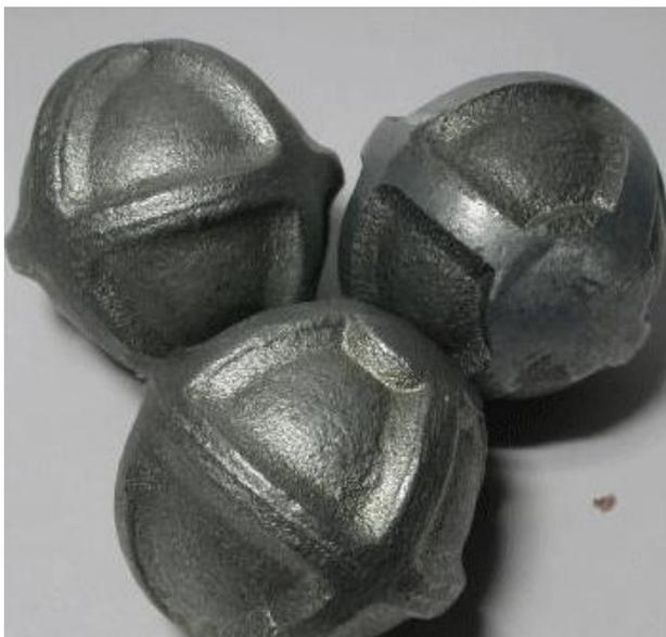
Anodi sacrificali per serbatoi interrati. Lo zinco è ossidato a preferenza del ferro, così queste palline di zinco (un pollice di diametro) vengono interrate vicino al manufatto di ferro e collegato ad esso con un conduttore.
