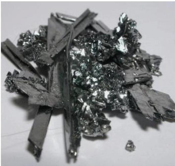
Cristalli di cromo ottenuti per elettrodeposizione
