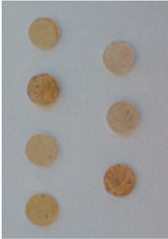
Le misurazioni sono state effettuate con uno spettrofotocolorimetro Macbeth 2020, specularità esclusa (tenendo conto delle caratteristiche superficiali delle pastiglie), area piccola di misura, filtro UV inserito.
