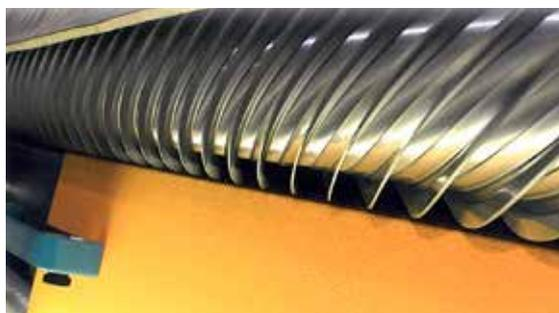
*Cilindro con lame elicoidali*
