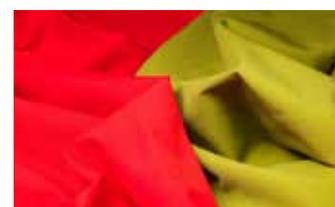
**Keprotect:** tessuto fatto con fibre aramidiche, tipo il kevlar e poliammide, che garantisce lunga durata, resistenza ad elevate temperature ed elevato livello di confort. Si usa per andare in moto, per abbigliamento da lavoro, sport attivi, guanti e scarpe.
