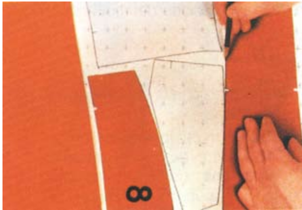
Tracciatura di contorno delle sagome
