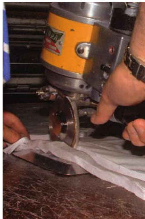
Taglierina circolare. Nell'esecuzione del taglio, il materasso si alza con possibile danno della precisione delle forme tagliate
